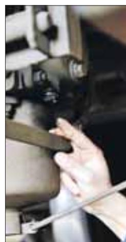
Auch das Steuerventil der Fahrzeugbremseinrichtung wird geprüft.
