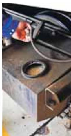
Die beheizte Sandstreuungseinrichtung eines Doppelstock-Steuerwagens
