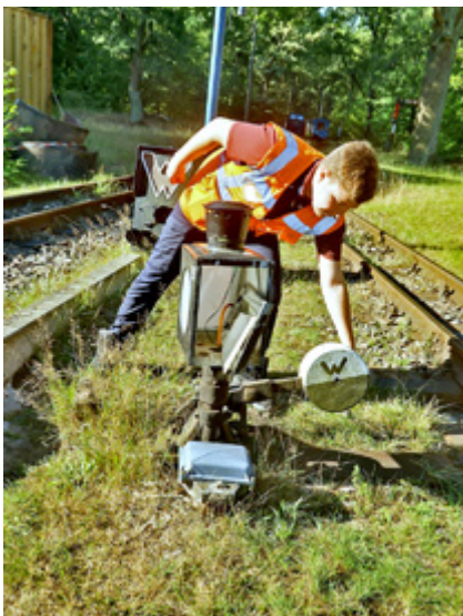
Da die Parkeisenbahn noch ein mechanisches Stellwerk hat, muss Dennis Redler die Weiche von Hand stellen.
