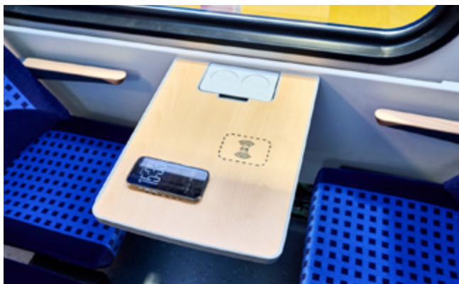
Praktisch: Im neuen Zug KISS lassen sich moderne Smartphones kabellos per Induktion aufladen.
