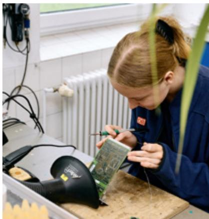
Fingerspitzengefühl ist gefragt, wenn die Mini-Bauteile auf den Platinen ausgetauscht werden.
