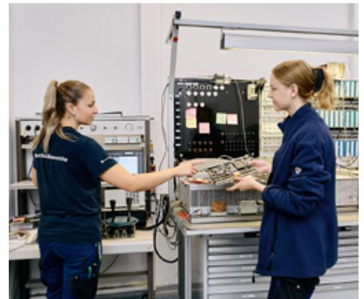
Das Team der Mikrowerkstatt testet an verschiedenen Prüfständen die Bordcomputer der S-Bahn Berlin.
