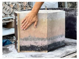
Recycelter Beton, hergestellt aus dem mineralischen Erbe des Spreeparks (Ziegel, Beton, Asphalt, vor Ort gefundene Natursteine wie Granit, Amphibolit, Gneis).
