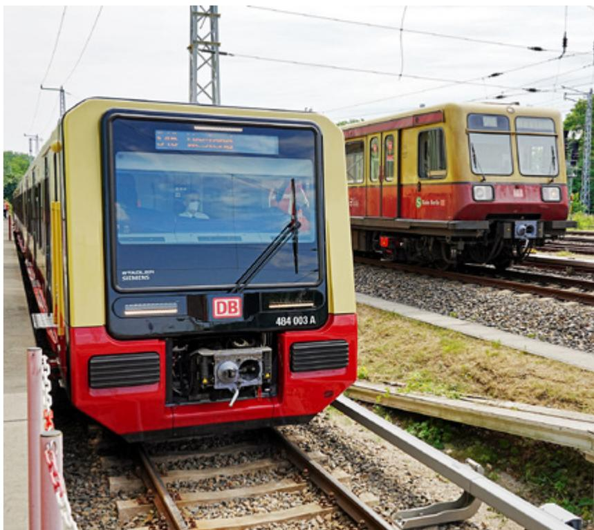
Generationswechsel: Die Baureihe 484 (links) löst auf der S46 die rund 30 Jahre alten Züge der Baureihe 485 (rechts) ab.
