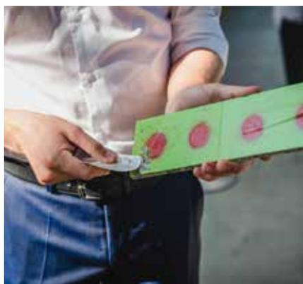
Dank neuer Anti-Graffiti-Beschichtung wird auch die Arbeit der Graffiti-Entferner einfacher und weniger Reinigungsmittel kommen zum Einsatz. Schmierereien können von den versiegelten Bahnhofswänden einfach abgekratzt werden.
