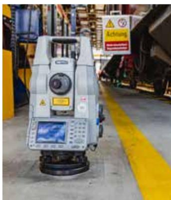
Ist die Kupplungsplatte noch in der richtigen Position? Wo vorher bei der Wartung noch von Hand gemessen wurde, wird nun digital per Laserkopf gemessen und gleich dokumentiert. Ungenauigkeiten wegen des Zugstandes rechnet das System heraus.
