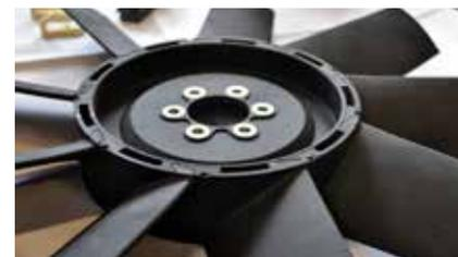
Kommt ebenso aus einem 3D-Drucker: ein Lüfterrad für einen Triebwagen
