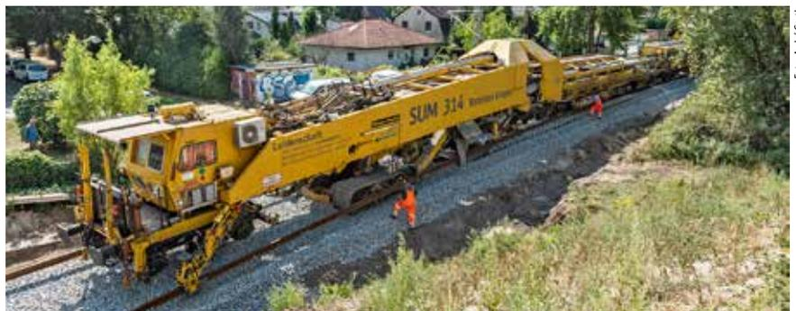
Wie am Fließband verlegt die Maschine Schwellen. Sie selbst wird von einer Lok geschoben an ihre Einsatzorte gebracht – heute Berlin/Brandenburg, morgen Magdeburg.
