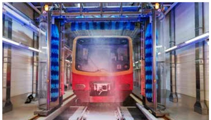
Die Waschanlage verfügt aus ökologischen Gründen über einen geschlossenen Kreislauf und nutzt das Wasser mehrfach.
