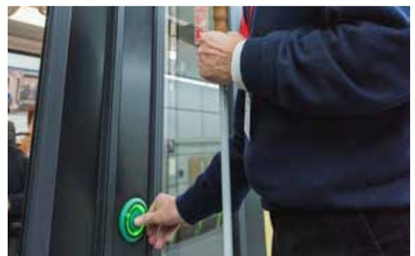
Die neue S-Bahn „spricht“ auch zu Kunden, deren Sehfähigkeit eingeschränkt ist. So gibt sie einen Türauffindeton und unterschiedliche akustische Signale beim Öffnen und Schließen der Türen ab.
