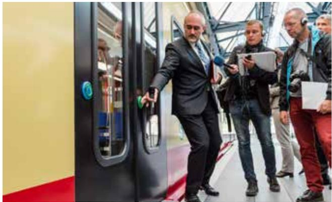
Jürgen Strippel, Projektleiter Neue S-Bahn bei der S-Bahn Berlin, präsentierte die automatisch nach dem Ein- beziehungsweise Ausstieg schließenden Türen. Sie bieten optische Signale – einer Ampel ähnlich in Rot und Grün.
