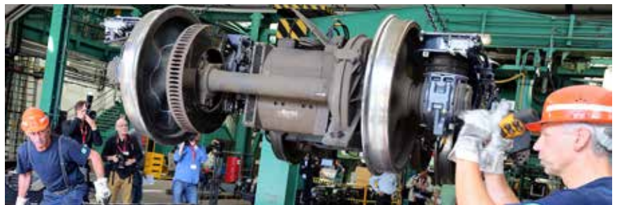
Das im Werk Schöneweide wieder komplett zusammengebaute Drehgestell kann an den Wagenkasten montiert werden.
