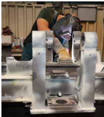
Zolt Kiraly schweißt an einem Drehgestellrahmen der Baureihe 480.
