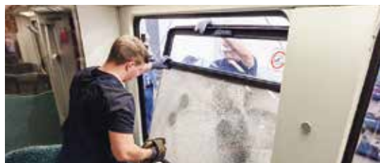
Zwei Mitarbeiter sind nötig, um eine zerschlagene Sicherheitsglasscheibe auszutauschen. Die Kosten dafür belaufen sich auf 600 Euro. Zum Glück kommt dieser Fall eher selten vor.
