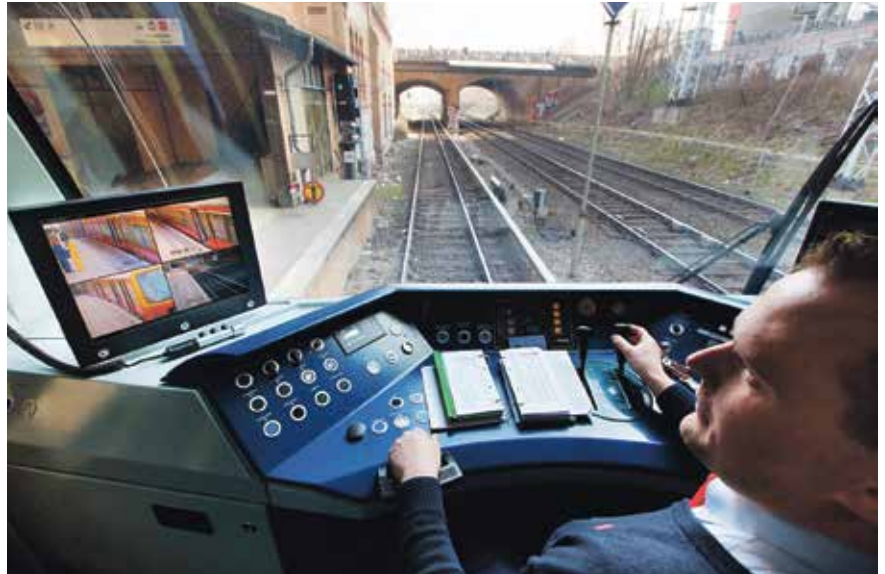
Triebfahrzeugführer Andreas Kühn hat per Monitor den gesamten Einstiegsbereich im Blick. Die Bilder werden über Funk bei der Zugeinfahrt übermittelt – die Authentifizierung geht in Sekundenschnelle.
