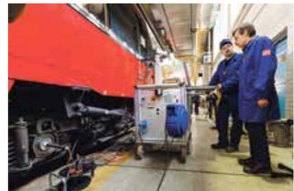
Vor der Ultraschallprüfung werden die Radachsen auf mindestens 5 Grad angewärmt.
