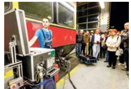
Mechatroniker Alexander Dybok prüft per Ultraschall die Achswellen.
