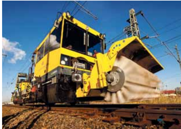
Dieser Bahnmotorwagen (BaMoWag) wurde für den Winterdienst mit einer rotierenden Bürste ausgestattet. Sie kommt bei geringen Schneefällen zum Einsatz, für stärkeren Schneefall wurden Fräsen nachgerüstet.
