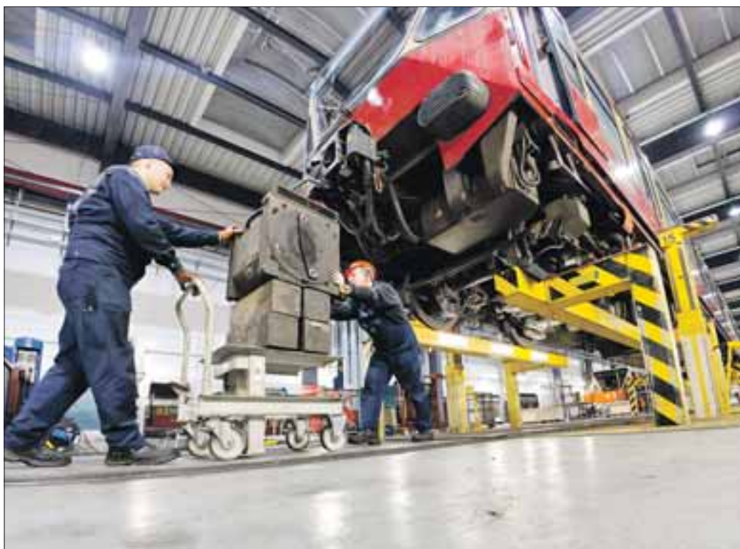
Mittels Hebebühne ist ein S-Bahn-Wagen wenige Meter vom Boden aufgebockt.
