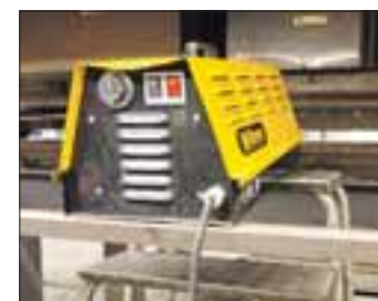
Mit Heizlüftern werden Drehgestelle enteist
