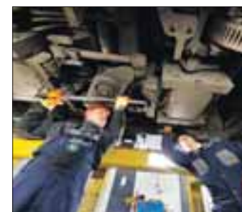
Schweißtreibende Arbeit für die Schlosser beim Motorentausch
